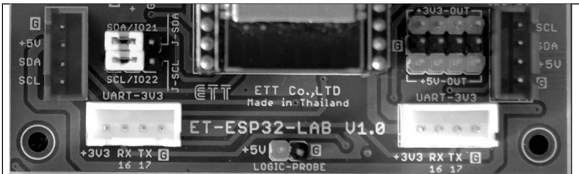
ภาพที่ 2-5 ขั้วต่อ UART-3V3 บนบอร์ด ET-ESP32 LAB V1.0
